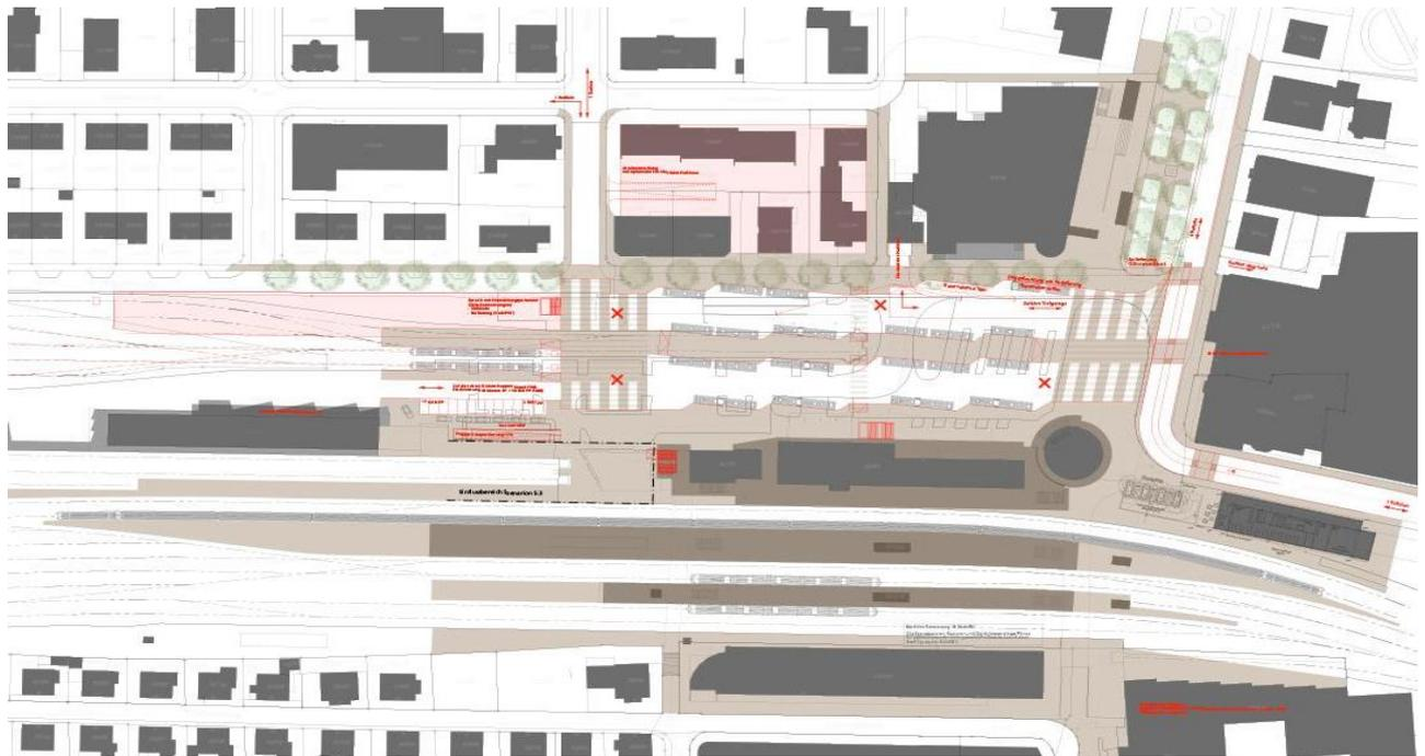
Abbildung 1: Konzeption des Bushofs mit Anordnung der Haltekanten, Fussgängerbereichen und Verkehrsflächen
