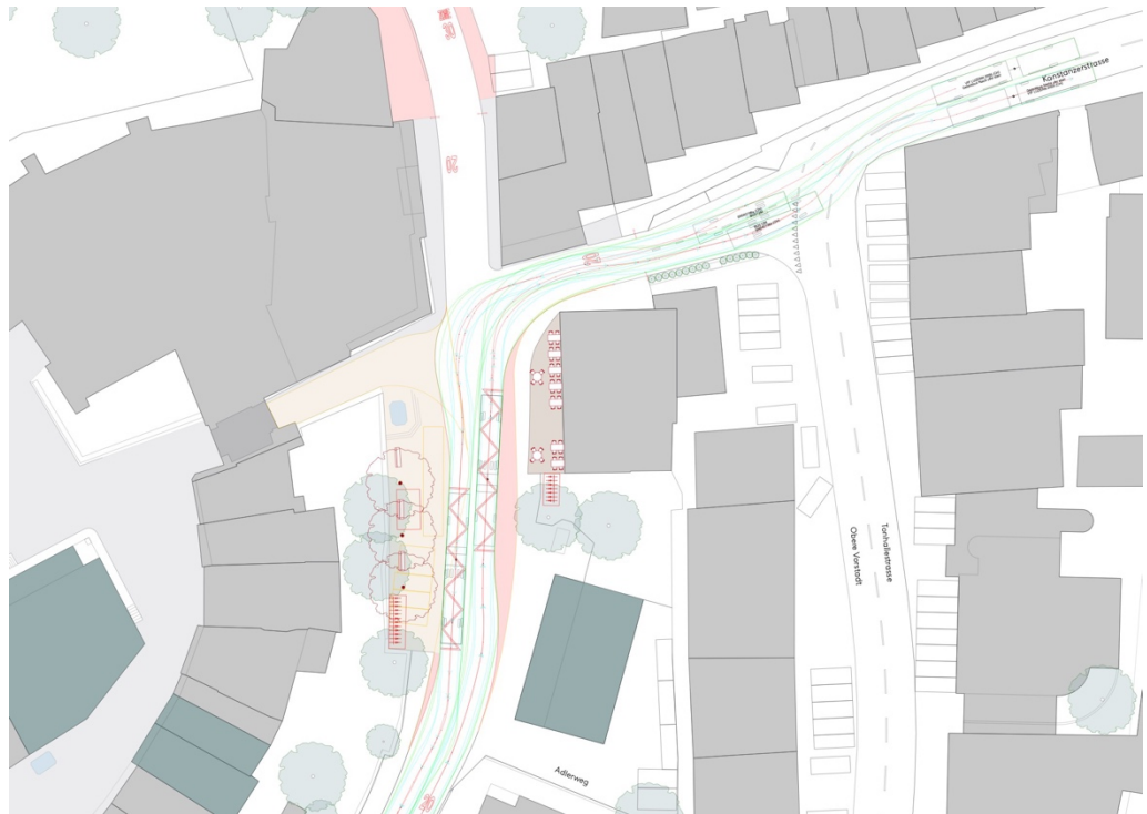
Abbildung 35: Bushaltestelle Adler (K4) mit Schleppkurven (Gelenkbus)
